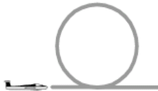
Figura 4-25 - Corretta esecuzione del loop intero
