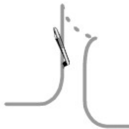
Figura 4-23 - Scampanata negativa con pre-posizionamento visibile
