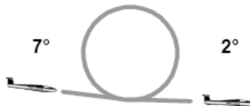
Figura 4-26 - Linee di ingresso e uscita dal loop
